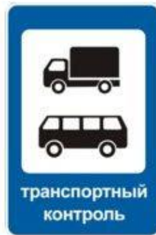
7.14 Пункт контроля международных автомобильных перевозок
